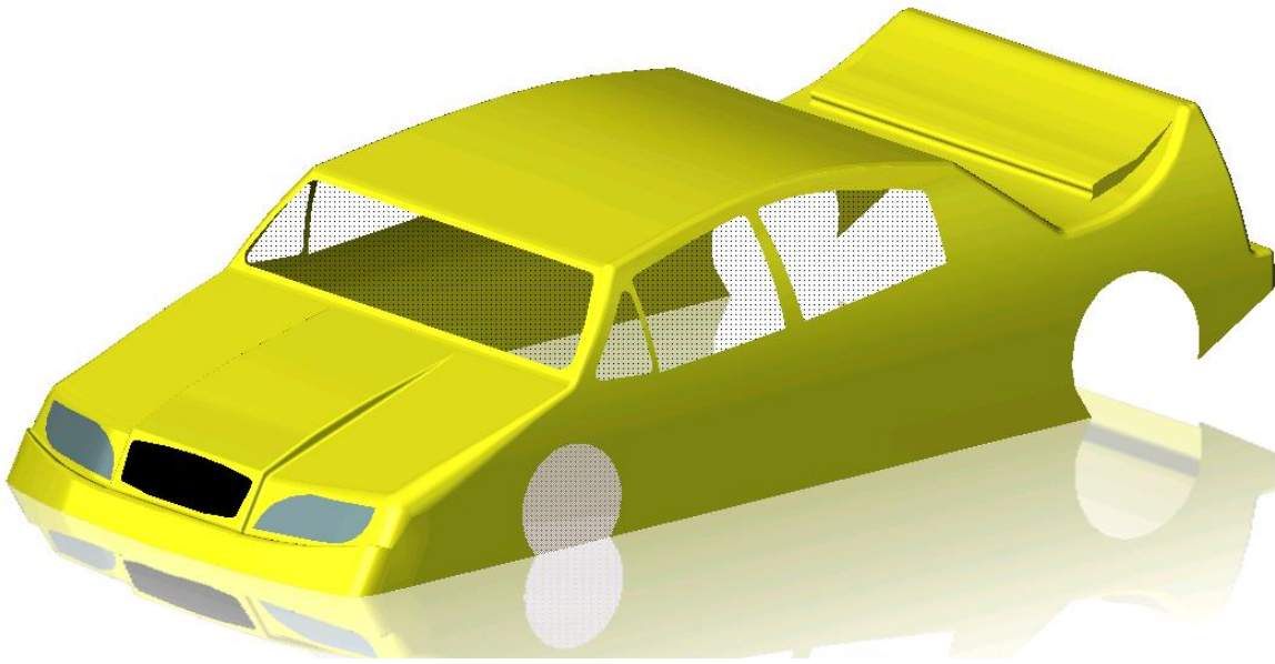
Etulokasuojat ja tuulilasi tulee jättää kirkkaiksi. Takalokasuojat leikataan auki.
